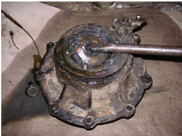
Abb. 5 Das Bild zeigt hier nur wie der Deckel herausgehoben wird. Der Achsantriebdeckel ist zu diesem Zeitpunkt natürlich noch am Getriebe angeschraubt.
